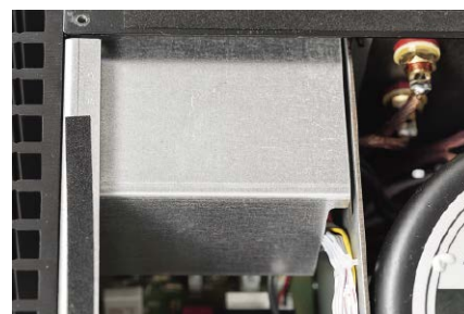
Cały moduł strumieniowy (wraz z nadajnikami i odbiornikami bezprzewodowymi) został odizolowany.
